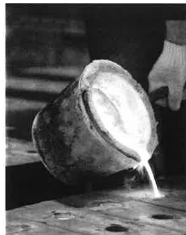
写真1. 金属をとかして型に入れて形を変える方法
